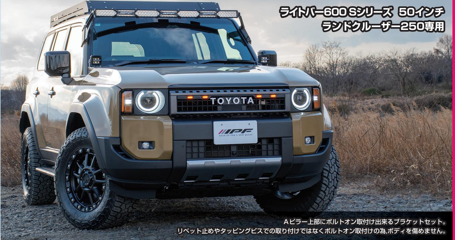
Aピラー上部にボルトオン取付け出来るブラケットセット。
