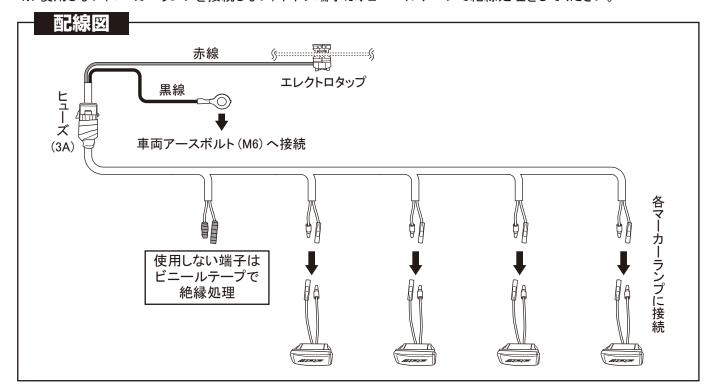
7. 5頁の 配線方法 配線図を参考にして、③ハーネスを下図のように配線してください。 フロントグリルに取り付けた①グリルマーカー RHと②グリルマーカー LHに③ハーネスを接続してください。 ③ハーネスが振れるおそれのあるところは、⑥結束バンドにて車両に固定してください。
