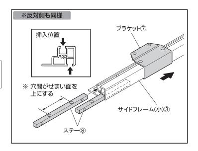
・サイドフレーム(大)②の横穴にステー⑧を挿入してサイドフレーム(小)③と連結し、トラスボルト(M8×15)⑪で固定します。
