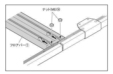
・ブラケット⑦とナット(M8)⑭をスライドさせて穴位置を合わせ、フランジ付ボタンボルト(M8×15)⑪で固定します。
