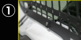
① 上下6カ所ので強固に固定 (引っ掛け固定)
