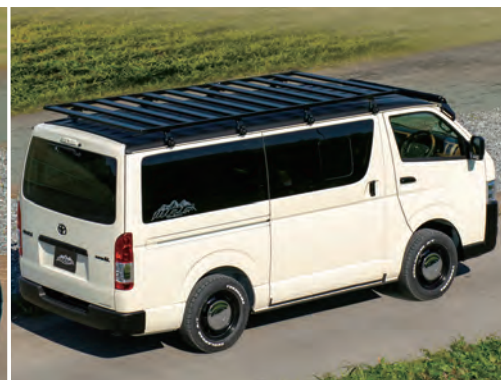
●錆に強いアルミ製フレーム採用 ●樹脂製コーナーカバー(ロゴ入り)
